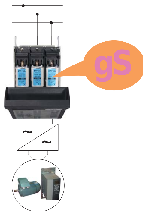
Rys. 2. Przykład zastosowania bezpieczników o charakterystyce gS
