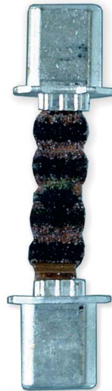
Rys. 3. Przepalony element topikowy bezpiecznika
