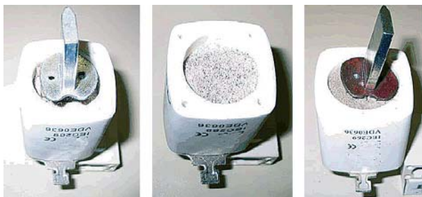
Rys. 4. Zbyt niski poziom piasku kwarcowego w komorze łukowej bezpiecznika
