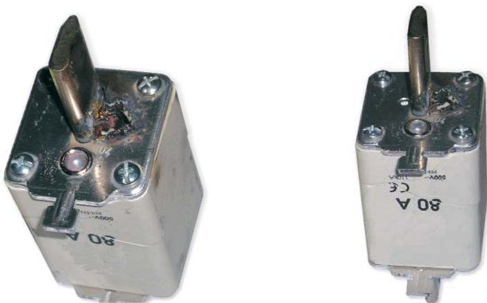
Rys. 5. Skutki wydostania się łuku elektrycznego na zewnątrz bezpiecznika na skutek zbyt niskiego poziomu piasku kwarcowego
